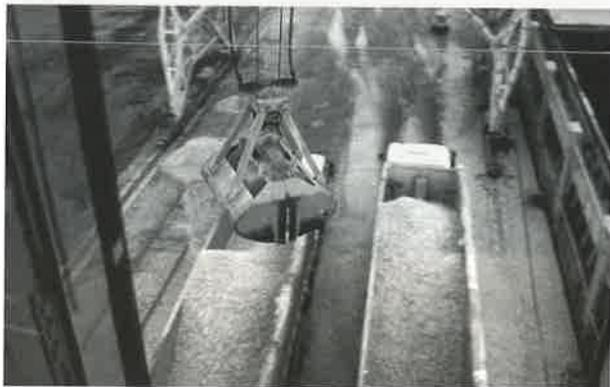
*Vue depuis le poste de conduite d'une grue du Port Autonome de Rouen. Sur le quai, 2 camions semi-remorques sont en cours de chargement de céréales à l'aide d'un «crapaud».*
